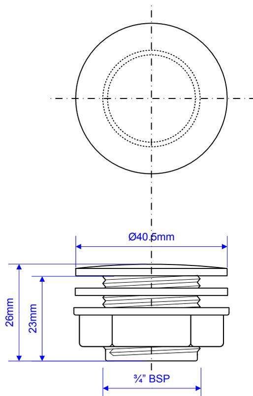
To Suit Sink Holes  $\text{Ø}26.0\text{mm}$  –  $\text{Ø}30.0\text{mm}$
